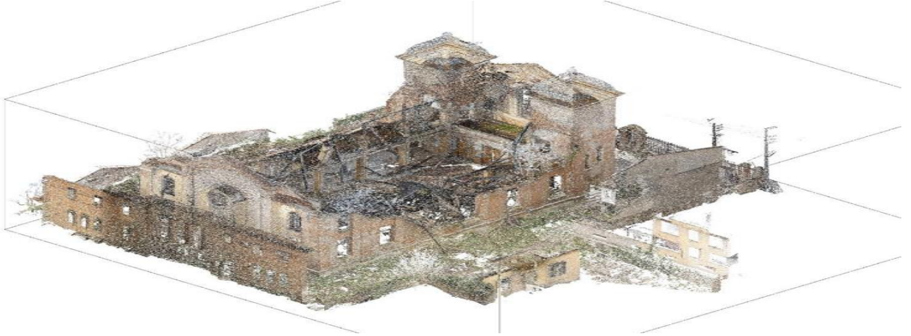
Şekil 6: Laser Scanner ile taranan Sinagog Binası Nokta Bulutu (Kaynak: Vakıflar Bölge müdürlüğü, 2007)
